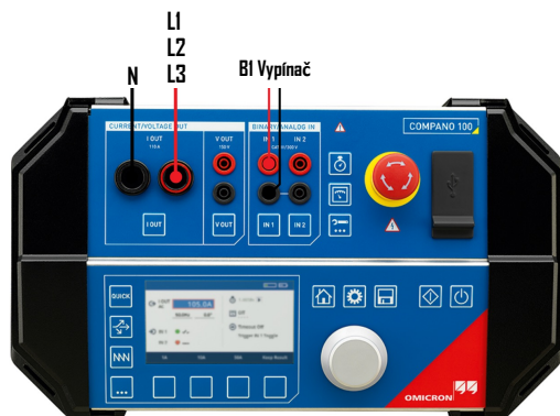
Obr. 11 Nadprúdové relé SEL-501 - testovanie
