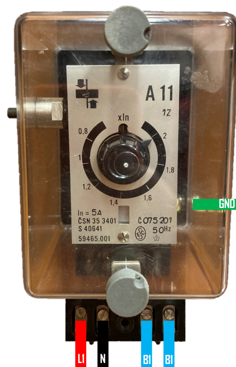
Obr. 13 Nadprúdové relé A11 - testovanie
