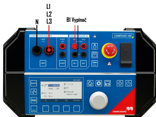
Obr. 13 Nadprúdové relé A11 - testovanie
